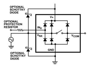
FIGURE 9. OVERVOLTAGE PROTECTION
