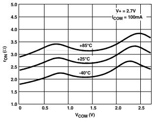
FIGURE 12. ON-RESISTANCE vs SWITCH VOLTAGE
