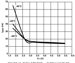
FIGURE 15. TURN-OFF TIME vs SUPPLY VOLTAGE
