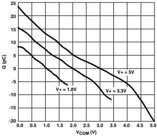
FIGURE 19. CHARGE INJECTION vs SWITCH VOLTAGE
