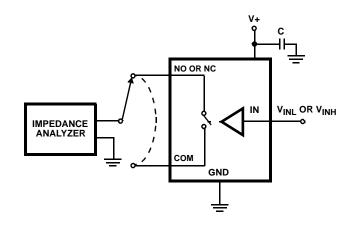
FIGURE 7. CAPACITANCE TEST CIRCUIT
