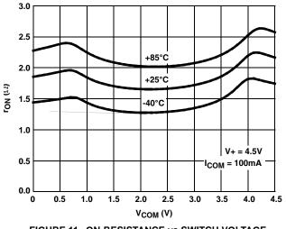
FIGURE 11. ON-RESISTANCE vs SWITCH VOLTAGE
