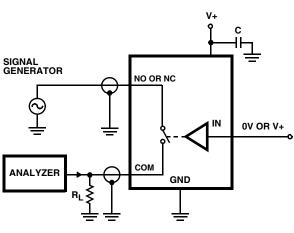
FIGURE 4. OFF ISOLATION TEST CIRCUIT
